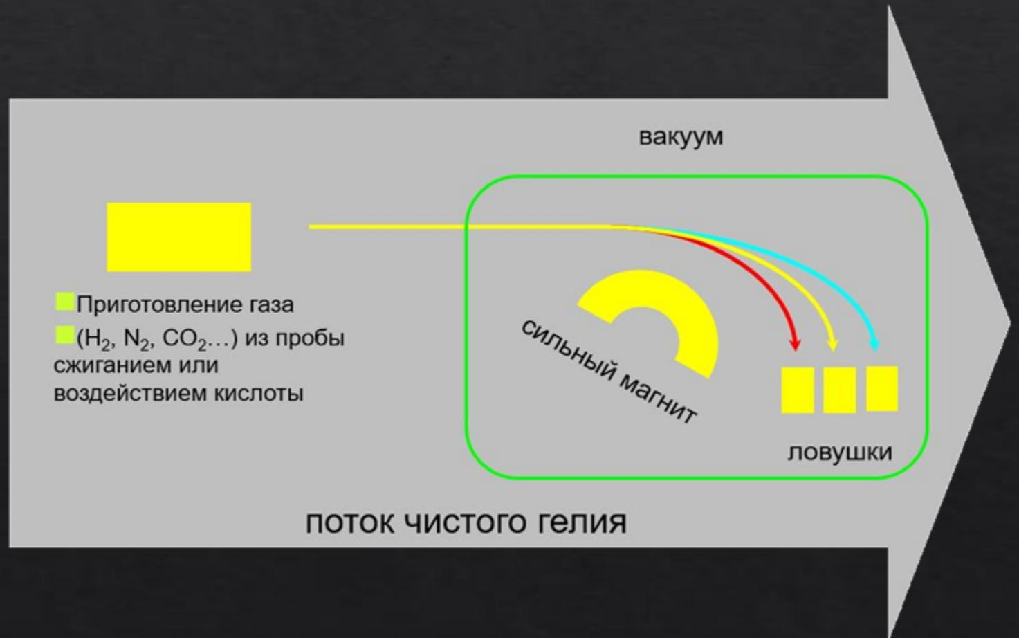
Схема механики изотопной спектрометрии из презентации д.б.н. Тиунова А. В.
